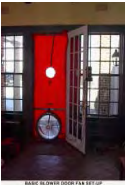
BASIC BLOWER DOOR FAN SET-UP
