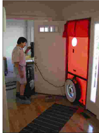
Blower Door Test
